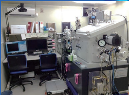
BL4Uキャビン内に設置された 走査型透過軟X線顕微鏡 (STXM)
