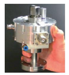
Fig. 1. Xenon-plasma discharge lamp
