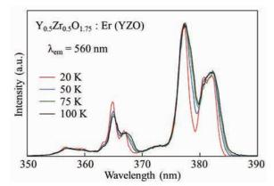
Fig. 2. Excitation spectra of  $Y_2Zr_2O_7$ : Er ( $\lambda_{em} = 560 \text{ nm}$ ).
