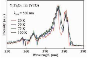
Fig. 3. Excitation spectra of  $Y_2Ti_2O_7$ : Er (  $\lambda_{em} = 560 \text{ nm}$  ).
