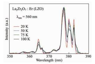
Fig. 1. Excitation spectra of  $La_2Zr_2O_7$ : Er (  $\lambda_{em} = 560 \text{ nm}$  ).
