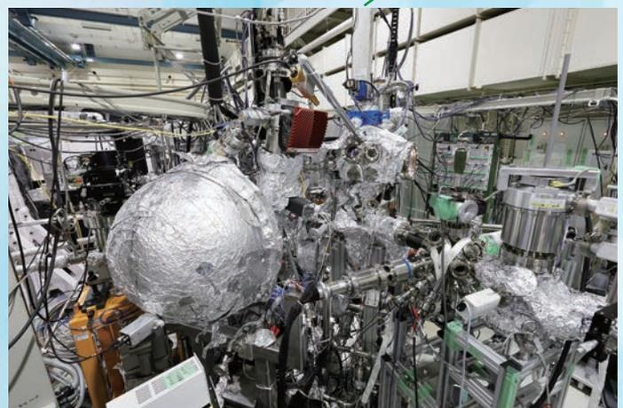
BL7U 高分解能角度分解光電子分光装置
