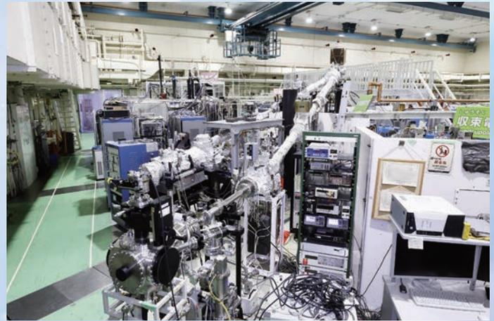
BL7B 吸収・反射・発光測定装置
