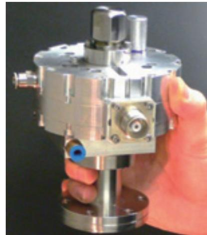
Fig. 1. Xenon-plasma discharge lamp
